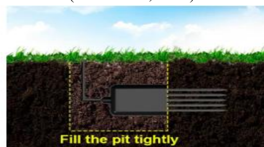
Figura 3: Instalação do Sensor CWT segundo o Método Buried Measurement
